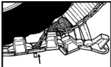
Insérer la chaîne de montage à travers un des maillons les plus longs sur la section au sol (voir l'illustration). **2**
