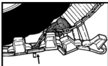
Efter bandpåläggning monteras kättingverktyget. Börja nerifrån och stoppa kättingverktyget igenom en av de förlängda länkarna, enligt bild.
