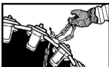
Lukitse kettinki työntämällä lukituspala kettinkilenki läpi. Tee vastaavanlainen kettingin asennus telan sisäpuolelle. Huomioi, että ulko-ja sisäpuolen kettingit tulee olla asennuksessa yhtä pitkinä. Aja telan liitoskohta telipyörien väliin ylös ja asenna sopivat liittimet.
