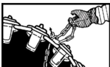
Verrouiller la chaîne en insérant l'extrémité libre à travers un maillon comme montré sur l'illustration. Une fois les deux chaînes montées, vérifier qu'elles sont de la même longueur des deux côtés. Avancer le véhicule jusqu'à ce que les chaînes se trouvent entre les roues du bogie. Connecter les extrémités de la chenille avec les fixations comprises dans le kit de montage. **4**
