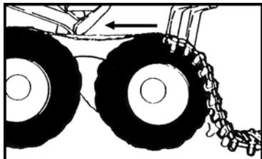
Dérouler la chenille et joindre les 2 sections à l'aide des fixations longues fournies dans le kit de montage. Rouler sur la chenille et amener l'autre extrémité sur le dessus du pneu afin que les deux extrémités se retrouvent à une extrémité du bogie.
