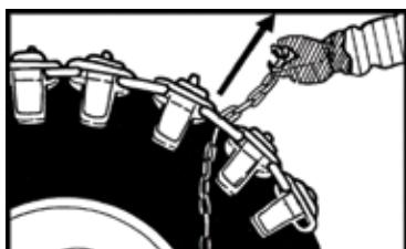
Insérer l'autre extrémité de la chaîne de montage à travers un des maillons les plus longs sur la section supérieure. Serrer la chaîne. **3**
