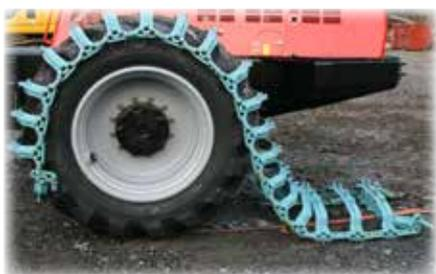
Tirer la chenille autour de la roue en faisant lentement avancer le véhicule
