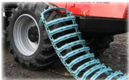
Positionner la machine de manière à ce que la roue soit en ligne avec la chenille. Passer le tirant autour de la roue. Placer le bout du tirant en avant de la roue.
