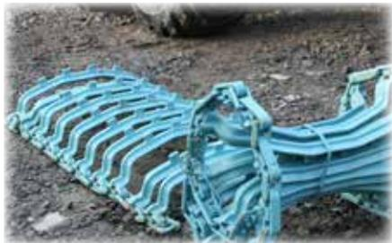
Dérouler deux sections de chenilles avec les taquets vers le haut. Utiliser une section présentant plusieurs fermetures et une section sans fermeture. Assurez-vous de placer les fermetures sur le côté extérieur du pneu.
